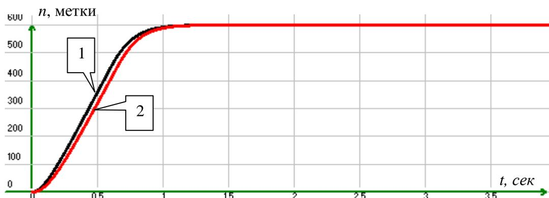
**Рис. 52** Переходный процесс в системе с ПИД+ПД-регулятором по положению: 1 – переходный процесс по положению в двигателе без нагрузки; 2 – переходный процесс по положению в двигателе с нагрузкой
