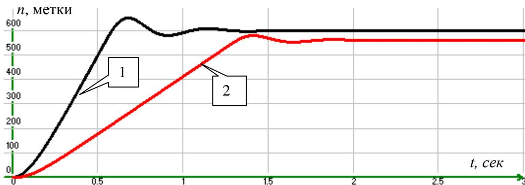
**Рис. 47** Переходный процесс по положению в системе с П-регулятором (положение измеряется в метках  $n$  по инкрементному энкодеру): 1 – переходный процесс по положению без нагрузки; 2 – переходный процесс по положению с нагрузкой на двигателе
